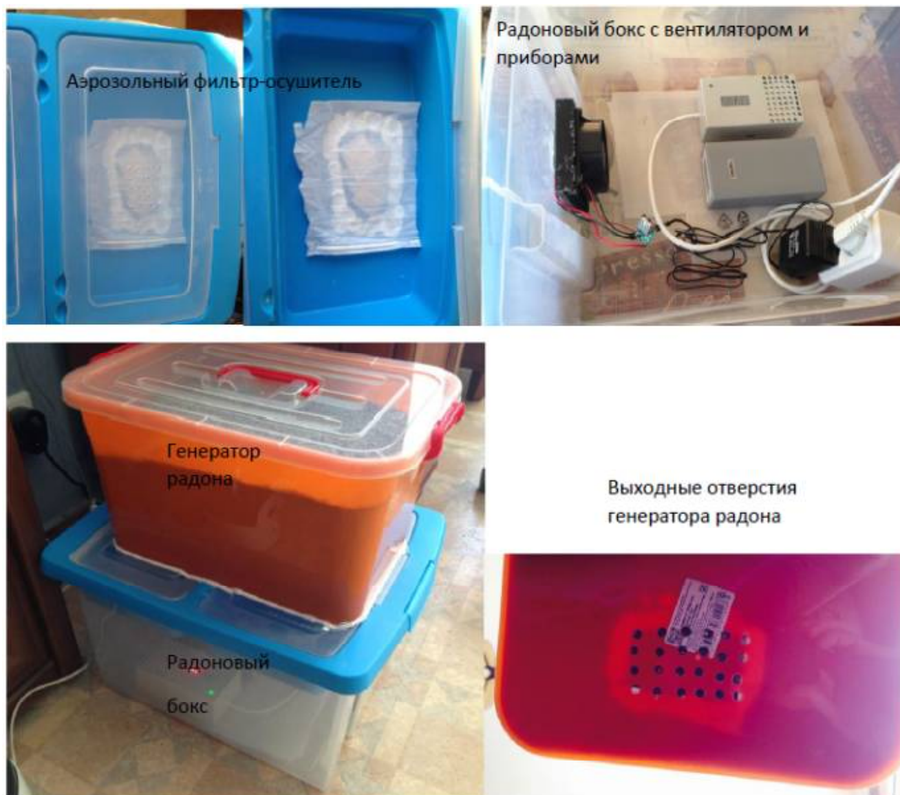
Рисунок 29 - Конструкция калибровочной установки с генератором, фильтром и боксом.
