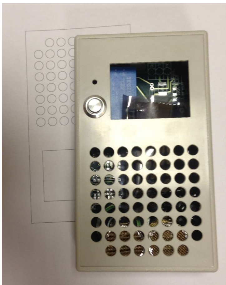
Рисунок 21 - Макет корпуса, изготовленный для сборки опытных образцов приборов и последующих испытаний.
