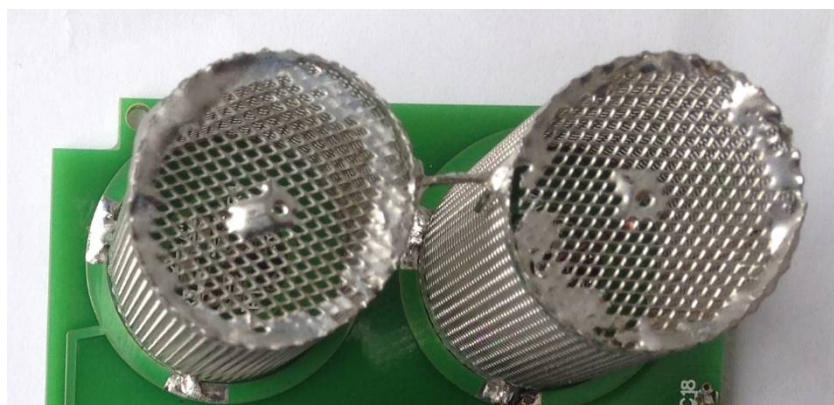
Рисунок 7 - Сборка из 2-х камер-ловушек на печатной плате.
