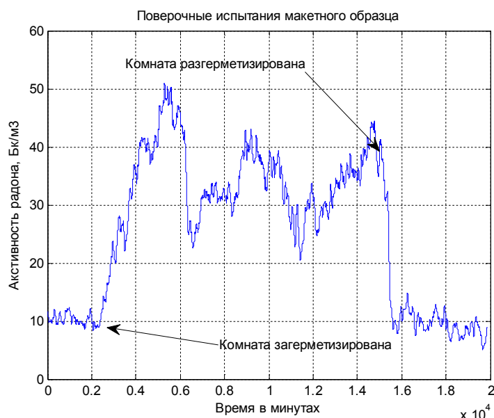
Рисунок 33 - Показания макета во время поверочных испытаний в комнате.
