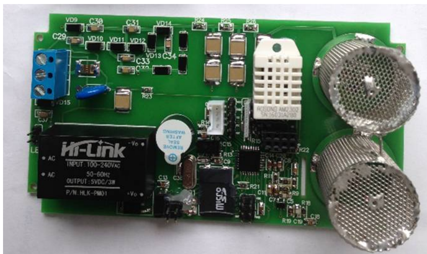
Рисунок 19 - Собранная электронная плата прибора.
