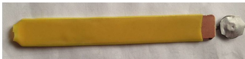
Рисунок 24 - Низкоактивный источник альфа-частиц, использованный для испытаний.
